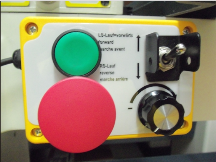
flyttbar manøverboks med magnet, inkludert nødstop, startknapp, regulering hastighet samt forver/revers bryter
